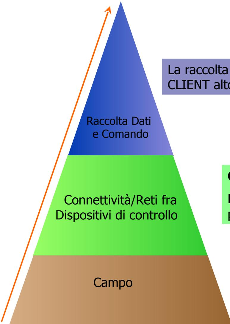
La raccolta dati viene tipicamente eseguita con un CLIENT lato PC ed un SERVER lato PLC.
