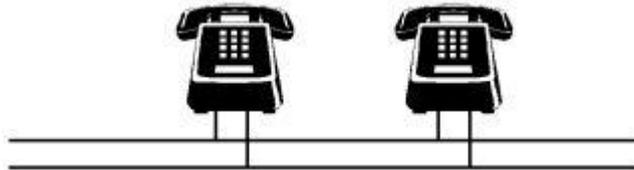
Con questo collegamento, ogni apparecchio telefonico è collegato tramite due soli fili, *a* e *b*. Inoltre non esiste alcuna gerarchia fra di essi.
