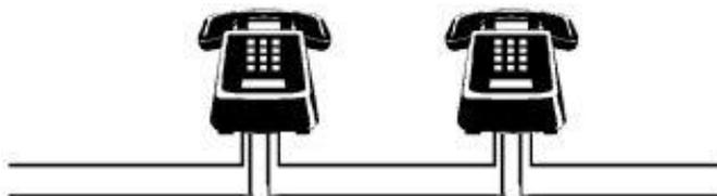
In realtà, dei quattro fili collegati ad ogni singolo apparecchio, solo tre sono effettivamente necessari giacché i fili *be* e *bu* solitamente sono collegati permanentemente fra loro come indicato nel seguente schema:
